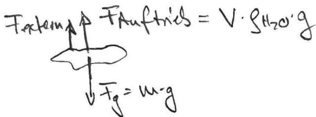
$$F_g = 70 \text{ kg} \cdot 9,8 \frac{\text{m}}{\text{s}^2} = 686 \text{ N}$$
