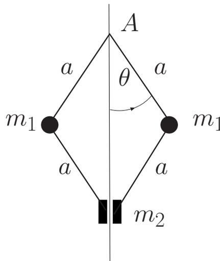
Diese Anordnung heißt Fliehkraftregler und wurde 1788 von James Watt als Drehzahlregler für Dampfmaschinen erfunden.
