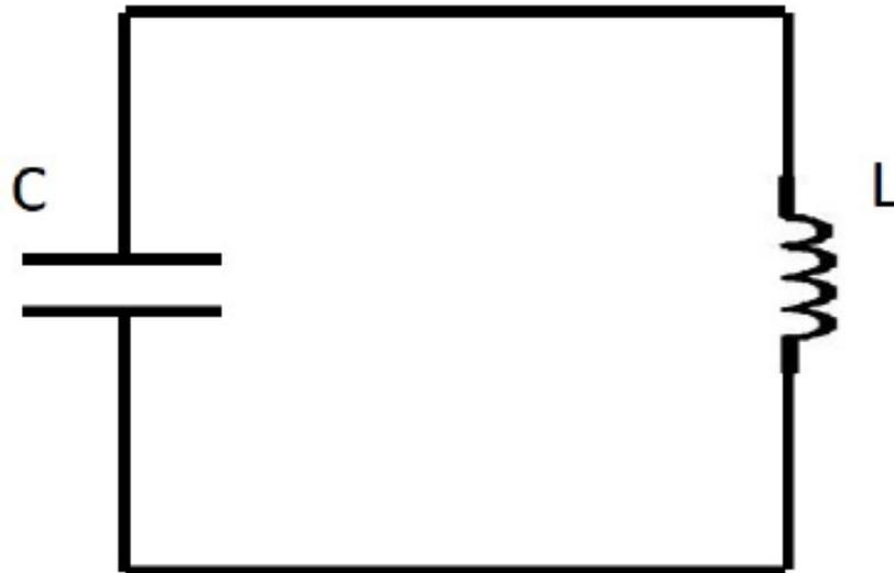
a) Im Folgenden soll das zeitliche Verhalten von Ladung, Spannung und Strom analysiert werden. Stellen Sie dazu unter Verwendung der Kirchhoffschen Regeln eine Differentialgleichung für den Schwingkreis auf. Lösen Sie die Gleichung mit einem Ansatz der Form  $Q(t) = Q_0 \cdot \cos(\omega_0 t)$  unter der Bedingung, dass zum Zeitpunkt  $t = 0$  die Ladung im Kondensator maximal ist. Bestimmen Sie insbesondere  $\omega_0$ .
