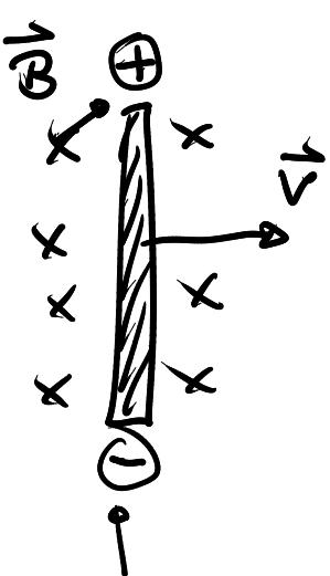
Kupferdraht bewegt sich  $\perp \vec{B}$  und  $\perp$  zu seiner Längsachse mit  $\vec{v}$
