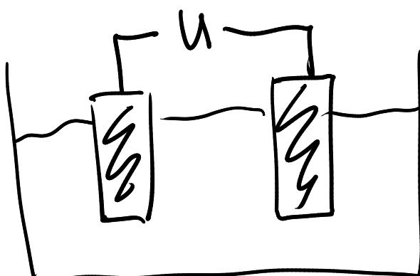
2 Metallplatten in einem Elektrolyten.
